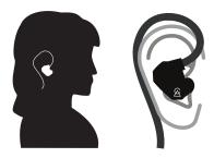
INSERT MAMMOTH INTO YOUR EAR WITH THE CABLE FACING FORWARD AND LOGO UPRIGHT. EARPHONES ARE MARKED 'L' FOR LEFT AND 'R' FOR RIGHT ON THE INWARD FACING WALL OF THE HOUSING. WRAP CABLE BEHIND EAR ONCE EARPHONE IS POSITIONED.
